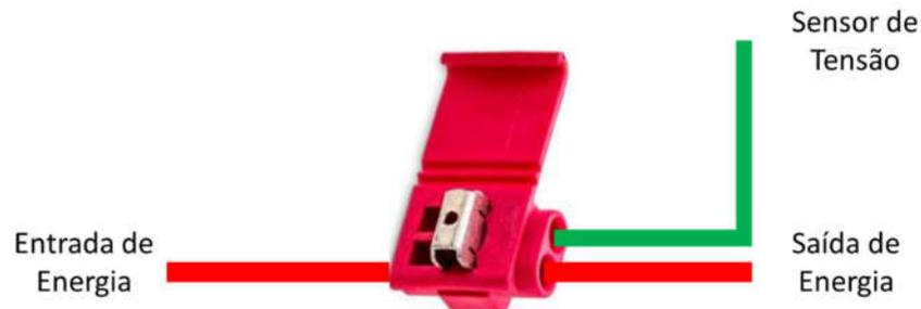
O conector de derivação deve ser selecionado de acordo com a bitola do cabo de energia da instalação. A entrada do sensor de tensão suporta cabos de bitolas de 26 a 12 AWG (0,13 a 3,31 mm<sup>2</sup>). De fato, a conexão do sensor de tensão (cabo verde na figura acima) pode ser feita com um cabo fino, sem prejuízo para o funcionamento do equipamento.
